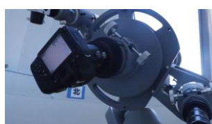
写真4 C-PL フィルターをつけて観測しているときのカメラ画面
