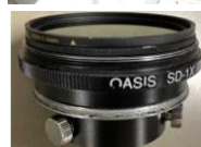
写真3 アイピースアダプターに C-PL フィルターを装着したようす
