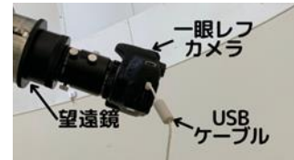
写真 2 一眼レフを使用した方法 (拡大撮影の場合)
